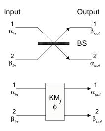
Figura 5.2. Representação dos modos de input e output dos elementos ópticos.
