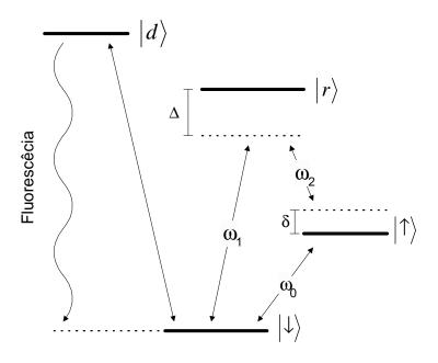
Figura 3.1. Diagrama dos níveis de energia eletrônicos de um íon interagindo com feixes laser de freqüências  $\omega_1$  e  $\omega_2$ , onde  $\delta = \omega_1 - \omega_2 - \omega_0$  ( $\delta \ll \Delta$ ),  $|r\rangle$  (eliminado adiabaticamente) é um nível auxiliar que indiretamente acopla os níveis  $|\uparrow\rangle$  e  $|\downarrow\rangle$ ,  $|d\rangle$  é um nível eletrônico usado para a medida de fluorescência utilizada para caracterizar o estado eletrônico.
