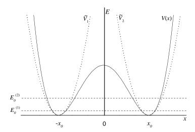
Figura 4.1. Representação esquemática (fora de escala) do potencial do tipo poço duplo V(x), das aproximações harmônicas locais  $\widetilde{V}_1$  e  $\widetilde{V}_2$  em torno de  $\mp x_0$  e dos dois níveis de menor energia das aproximações harmônicas.
