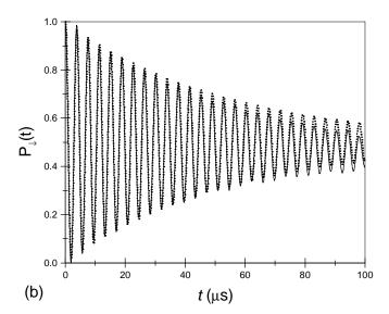
Figura 3.4. Evolução temporal da probabilidade de medida do estado fundamental  $P_{\downarrow}(t)$  para os estados iniciais iônicos (a)  $|n=0,\downarrow\rangle$  e (b)  $|n=1,\downarrow\rangle$ , de acordo com nosso modelo (linha cheia) e segundo a relação heurística (3.71) (linha pontilhada).
