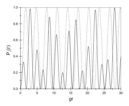
Figura 4.3. Comportamento da função  $\mathsf{P}_{\downarrow}(t)$ , no regime carrier, para os valores  $\mathcal{R}^{(2)}/(\hbar g)=0$  (linha pontilhada) e 1 (linha cheia).
