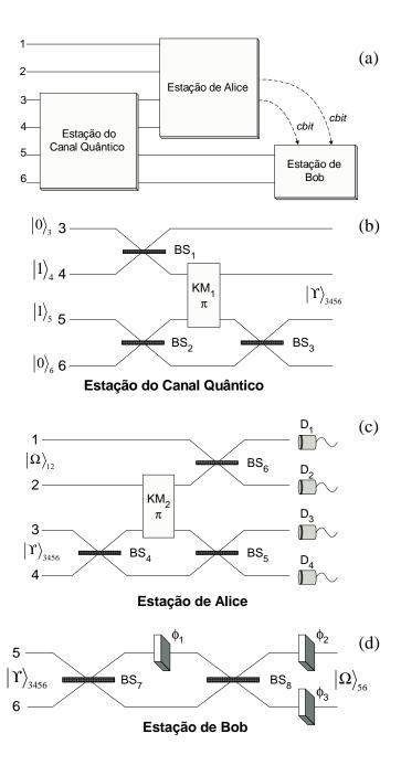
Figura 5.1 (a) Esboço do arranjo experimental para o teletransporte quântico de emaranhados de zero e um fóton do campo propagante. (b) Estação usada para gerar o canal quântico. (c) Estação de Alice. (d) Estação de Bob.
