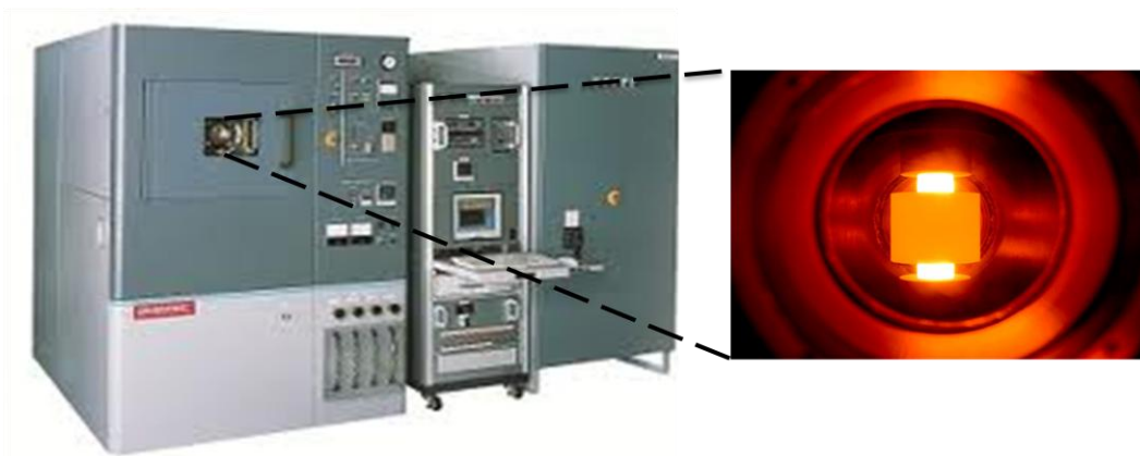
Figura 14: Equipamento de SPS da marca japonesa SPS Syntex (modelo SPS-1020).
