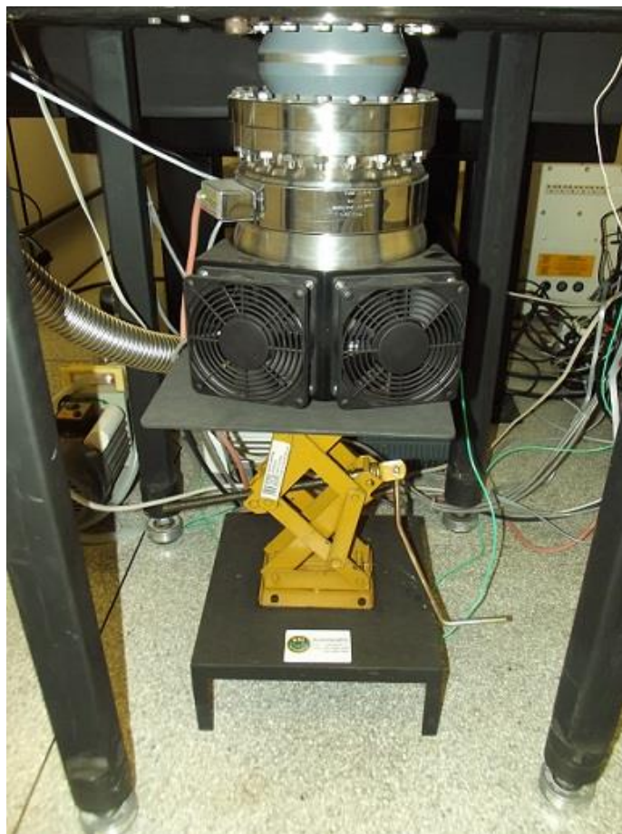
Figura 49 – Suporte com plataforma. Na imagem ainda se observa a bomba turbo e o anel anti vibração.
