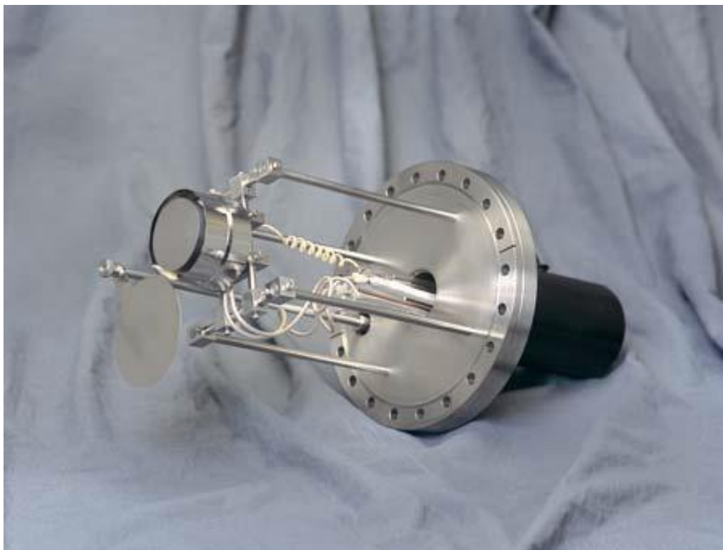
Figura 8 - Aquecedor (heater) de 2" com flange de 8". O que se observa neste tipo de aquecedor é um disco na parte superior que serve como blindagem que pode ser utilizado, por exemplo, durante a pré ablação do alvo 40 .
