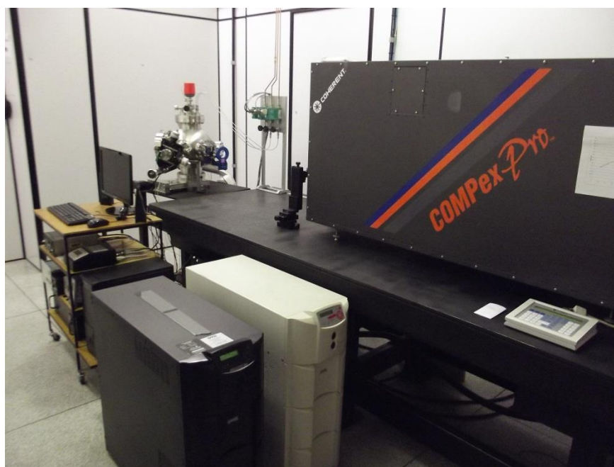
Figura 55 – Imagens da montagem final do sistema de PLD.
