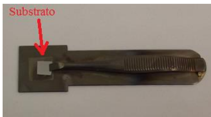
Figura 60 - Substrato de STO fixado na parte superior do suporte.
