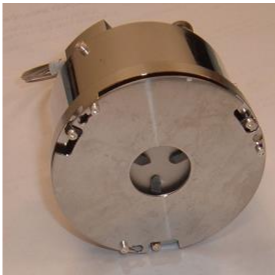
Figura 52 - Heater de 2 polegadas de diâmetro com tampa protetora e presilhas.
