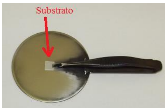
Figura 62 - Suporte com as mesmas dimensões da placa já existente no heater com substrato fixado pela presilha.
