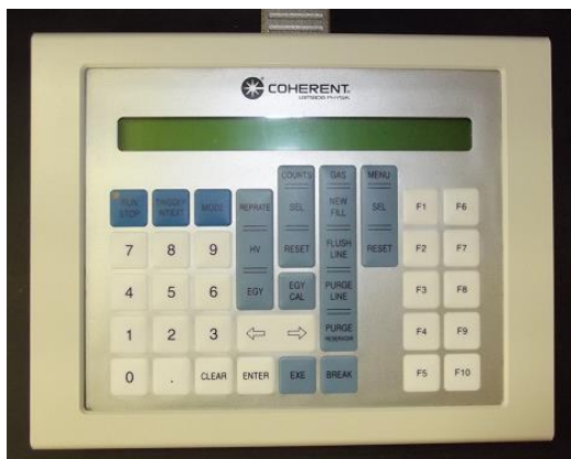
Figura 35 - Teclado externo onde são inseridos todos os comandos do laser.
