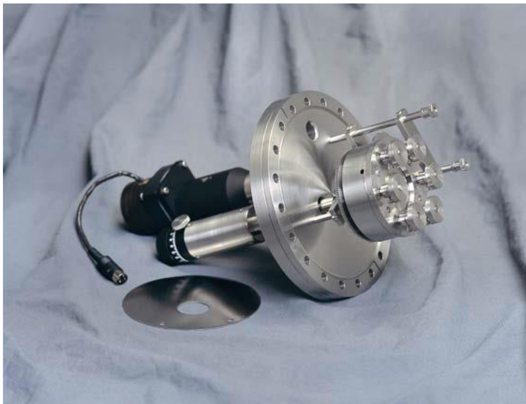
Figura 7 - Fixador de alvos do tipo carrossel para 6 alvos com flange de 8” 40 .
