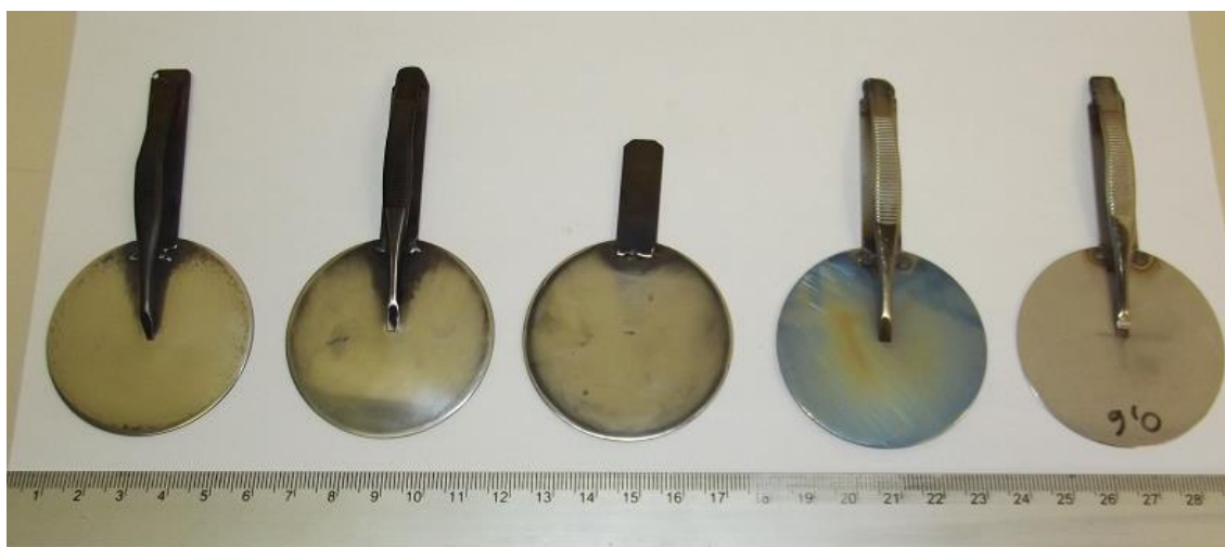
Figura 61 - Suportes com o mesmo diâmetro da placa já existente no heater com hastes e presilhas soldadas. Cada suporte tem espessura diferente que variaram de 0,6 mm a 0,8 mm.
