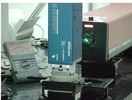
Figura 5-4: A figura mostra um laser de Argônio na linha 5145 (verde), como fonte de luz. À frente do laser aparece um filtro que evita (filtra) as possíveis linhas de plasma do laser na região do espectro a ser observado.
