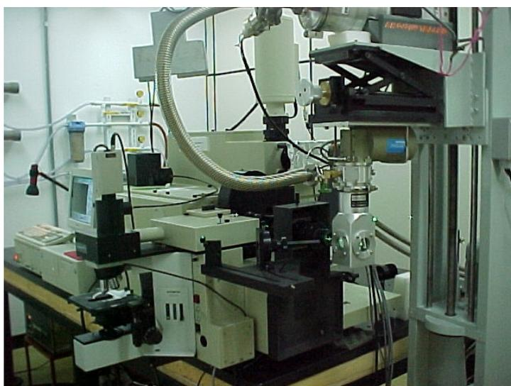
Figura 5-2: A figura mostra o criostato de ciclo fechado de Hélio líquido (lado direito e a frente), o sistema de macro (atrás do criostato) e micro (lado esquerdo e a frente) Raman, o espectrômetro (centro, logo atrás do sistema de macro e micro Raman), o microcomputador (fundo e atrás do espectrômetro) e finalmente a interface Spectralink (lado esquerdo e no fundo).
