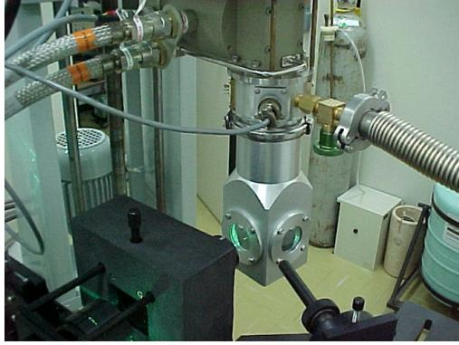
Figura 5-5: Criostato: sistema de refrigeração onde a amostra é mantida em baixa temperatura.
