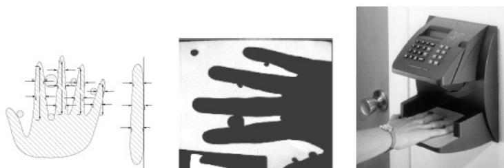
**Figura 2.32: Processo de aquisição, Modelo esquemático da palma da mão (esquerda), Imagem real (centro) adquirida pelo dispositivo (direita) (COSTA L. R.; OBELHEIRO; FRAGA, 2006).**
