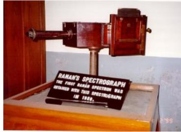
*Figura 2\_I - Espectrógrafo utilizado por Raman em 1928 em seu primeiro experimento de espalhamento de luz.*
