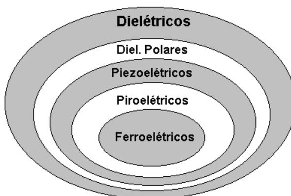
**Figura 5-** *Classificação dos materiais ferroelétricos como subgrupo dos dielétricos polares.*
