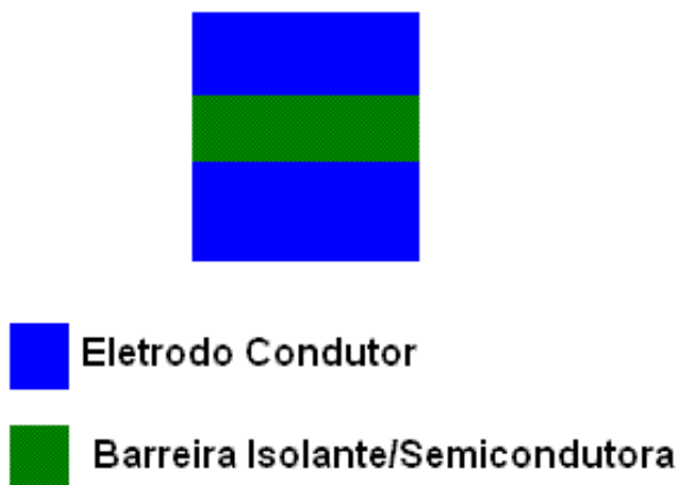
Figura 3 - Representação esquemática de uma Junção Túnel
