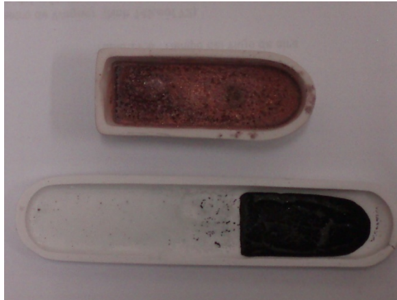
Figura 5.4 – Cadinhos utilizados para o processo de magnetização da grafite magnético.
