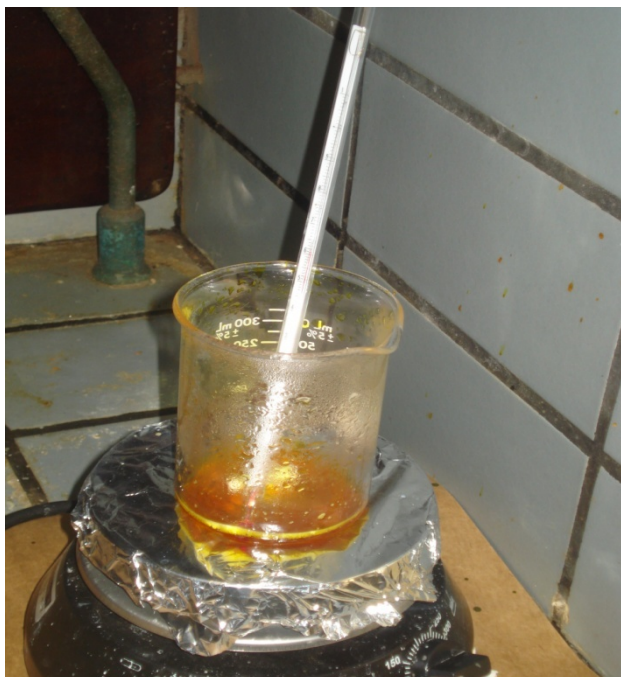
Figura 5.1 – Foto representativa do arranjo experimental do processo de obtenção de nanopartículas de óxido de ferro por sol-gel.
