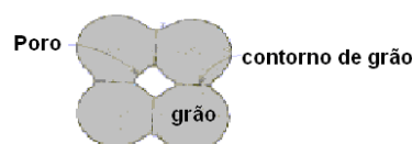
Figura 6 – Esquema representativo das partes principais que compõe um corpo cerâmico
