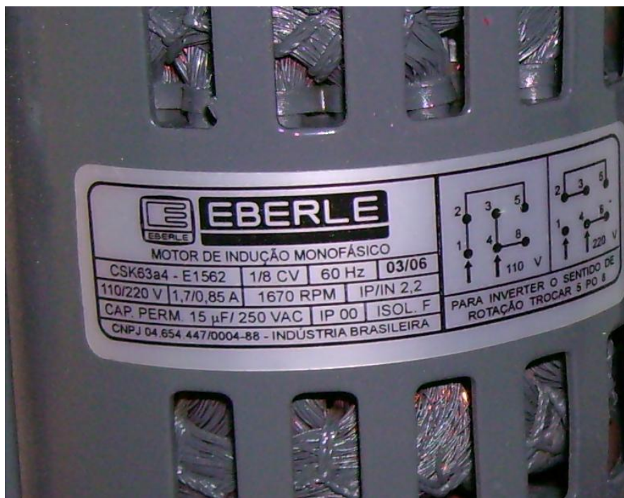
Figura 3- Detalhe das especificações técnicas do motor de uma máquina de costura em que não se explicita diretamente a potência consumida, mas, sim, a tensão, a corrente e a potência útil em cavalo-vapor.
