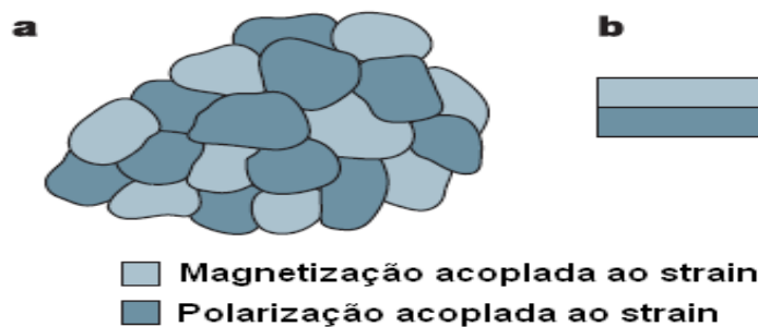
Figura 4- Acoplamento magnetoeletrônico via deformação em sistemas de duas fases em a) mistura de grãos b) heteroestruturas de filmes finos [5].
