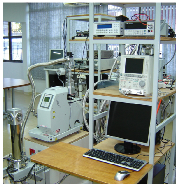
Figura 13: Esquema de montagem dos equipamentos para medidas elétricas usando o eletrômetro Keithley 6517A e controlador de temperatura Lake-Shore LS331S; ao lado a estação experimental na qual foram realizadas as medidas.
