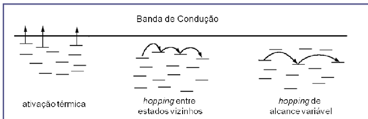
Figura 2: Processos de condução de corrente em semicondutores. Banda de condução significa estados estendidos, livres para a condução de corrente. Estados localizados referem-se a qualquer estado no qual os portadores podem ficar presos, como por exemplo, um defeito na rede. O processo (1) é a conhecida ativação térmica; o processo (2) é o processo conhecido como nearest neighbour hopping (NNH) e o processo (3) é conhecido como variable range hopping (VRH).
