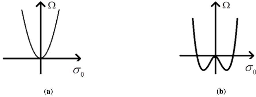
**Figura 6 – Representação esquemática da energia livre como função do parâmetro de ordem a)  $T > T_c$  antes da ocorrência da transição b)  $T < T_c$ , depois da ocorrência da transição.**
