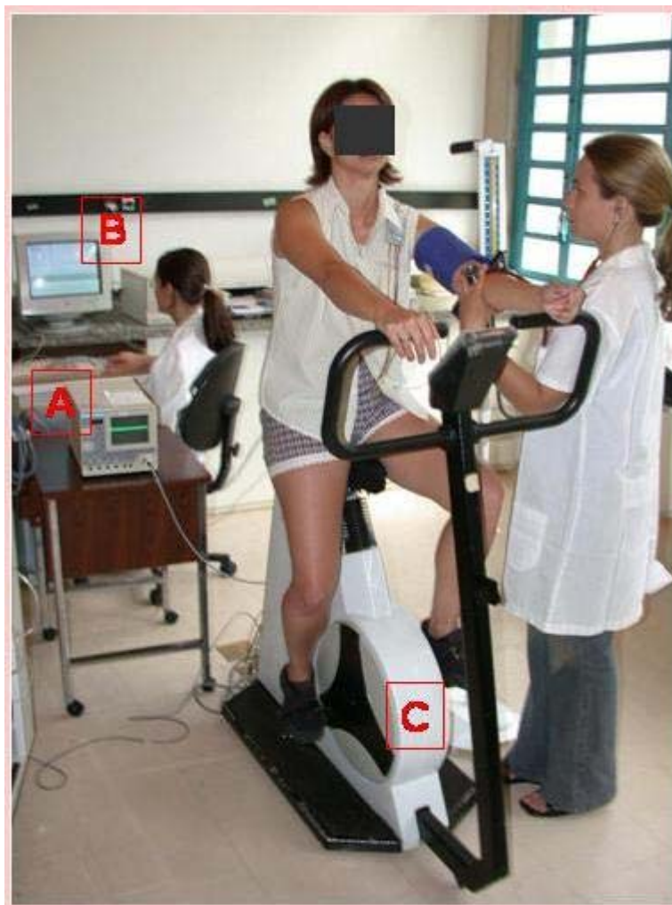
Figura 6 Ilustração da montagem experimental do teste de exercício físico dinâmico de carga constante. A: Monitor cardíaco; B: computador com o software de aquisição dos dados de frequência cardíaca; C: cicloergômetro de frenagem eletromagnética.
