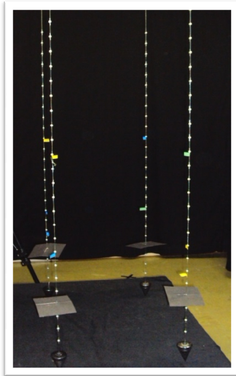
Figura 8. Sistema para calibração do sistema de análise de movimento.
