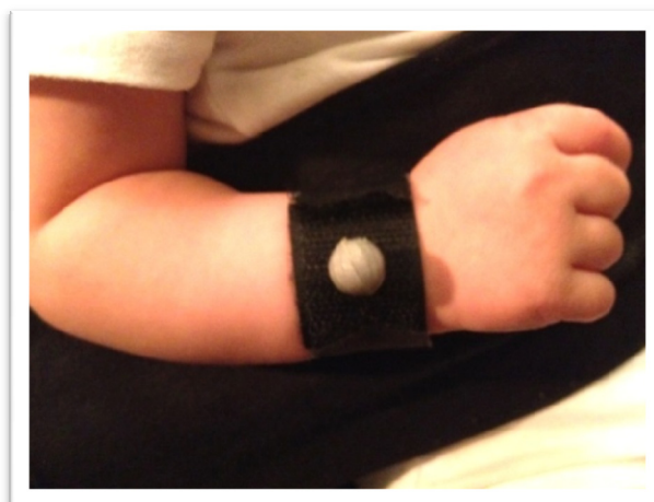
Figura 4. Marcador confeccionado para rastreamento do alcance para análise cinemática.
