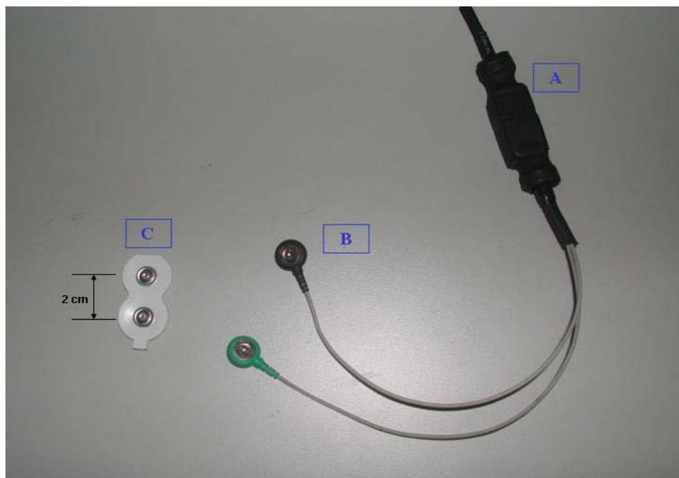
Figura 5. A: eletrodo bipolar diferencial ativo simples; B: terminais de acoplamento ao eletrodo de Ag/AgCl; C: eletrodos de superfície de Ag/AgCl.
