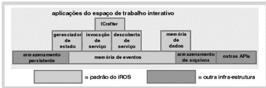
Figura 3. 5 - Arquitetura da Infra-estrutura iROS – adaptada de [JOH, 2002].
