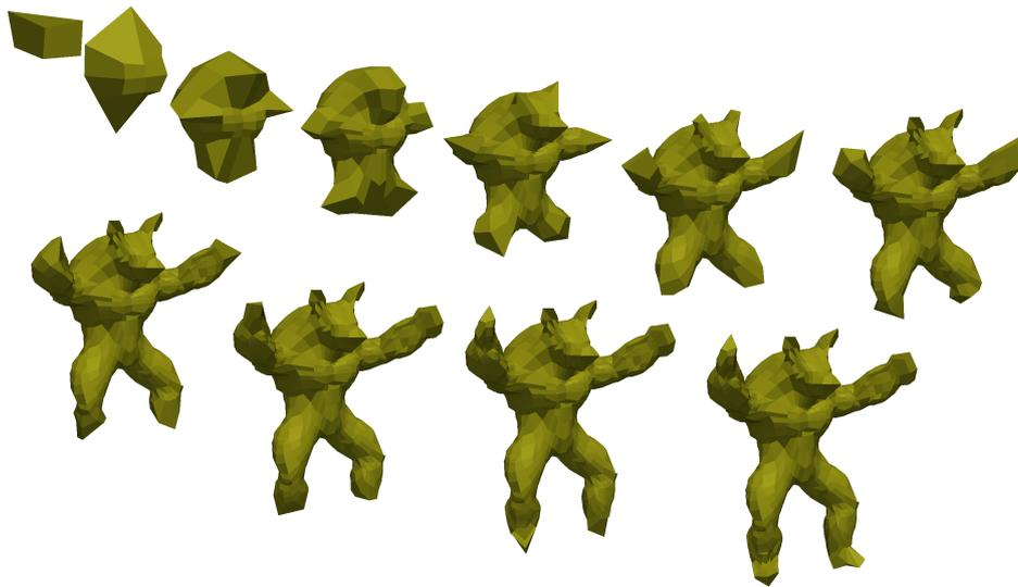
Figura 4.11: Exemplo do processo iterativo desde a malha base até a malha final, com 10 iterações (partindo do modelo inicial, acima e a esquerda).
