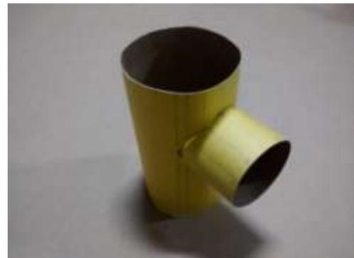
Intersecção 90° de diâmetros diferentes construída por aluno.
