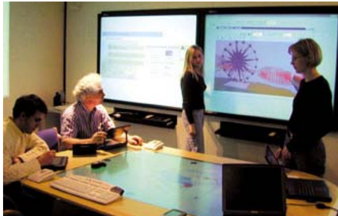
Figura 2.3 - Sala interativa iRoom – lousas eletrônicas sensíveis a toque, mesa de projeção, notebooks .
