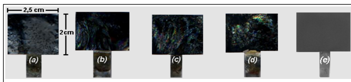
FIGURA 3.8 - Fotografia dos eletrodos de Ti-Pt/PbO 2 -Fe,F produzidos (sem a utilização do aditivo LSS) em diferentes densidades de corrente: (a) 5 mA cm -2 , (b) 10 mA cm -2 , (c) 15 mA cm -2 (d) 20 mA cm -2 e (e) 20 mA cm -2 com LSS.
