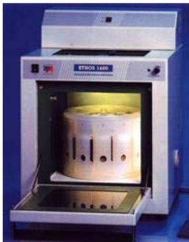
**FIGURA 4.1.** ETHOS 1600 Milestone equipado com 10 frascos de Teflon PFA. Potência máxima: 1000 W e Pressão máxima: 110 atm<sup>65</sup>.
