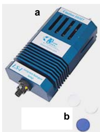
Figura 2.3 – (a) Fonte de radiação, lâmpada de tungstênio-halogênio, (b) discos de Teflon.
