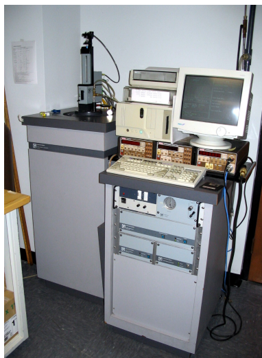
Figura 15: Magnetômetro SQUID completo, incluindo gabinete do dewar, dewar, controlador geral, fonte do magneto supercondutor, controlador de temperatura, unidade de potência, unidade de controle de fluxo de gás do magneto, microcomputador e monitor.
