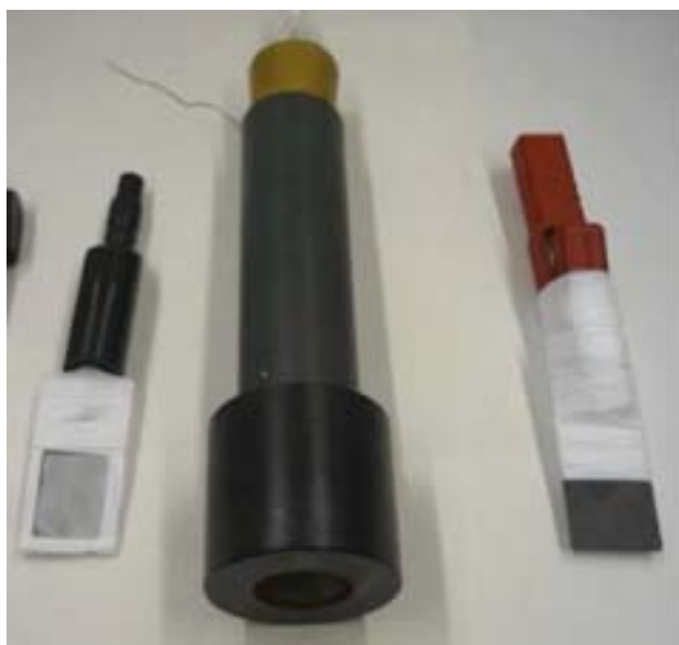
FIGURA 3.2 – Eletrodos empregados. Da esquerda para direita: aço inoxidável AISI 304, difusão de gás e DDB.
