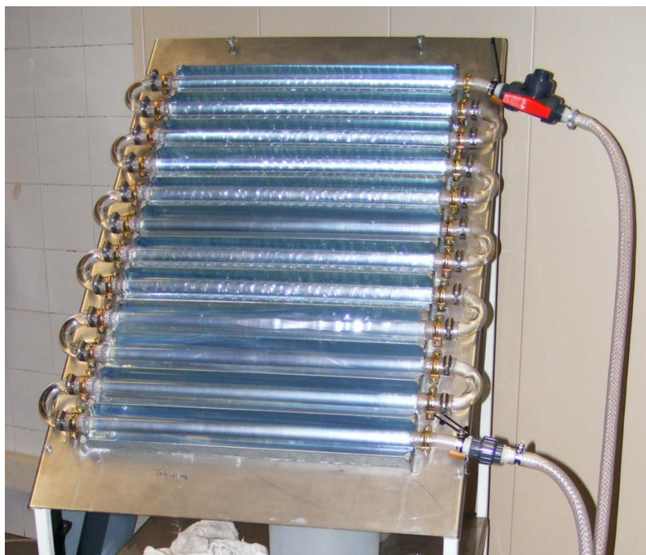
FIGURA 3.7 – Fotorreator solar empregado na planta piloto de fluxo.
