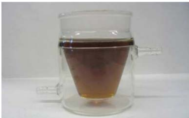
FIGURA 3.1 – Célula eletroquímica empregada nos estudos da degradação da solução do corante AR 29.
