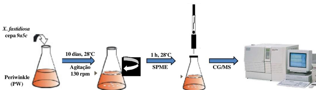
ESQUEMA 3.3: Extração dos compostos voláteis utilizando Microextração em fase solida.
