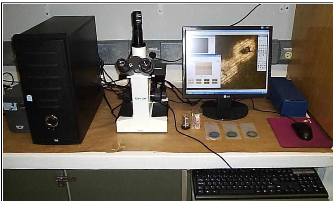
FIGURA 2.1: Microscópio óptico invertido com sistema digital de captura e processamento de imagem fotografadas ou filmadas.
