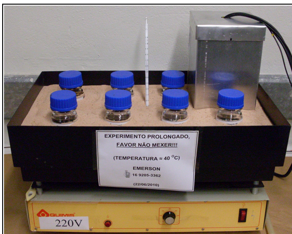
FIGURA 2.8: Banho de areia utilizado para controle de temperatura a 40 °C durante as medidas de ruído eletroquímico
