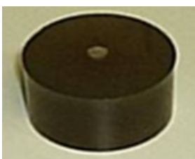
FIGURA 2.5: Corpo de prova de aço AISI 1020 embutido em resina.
