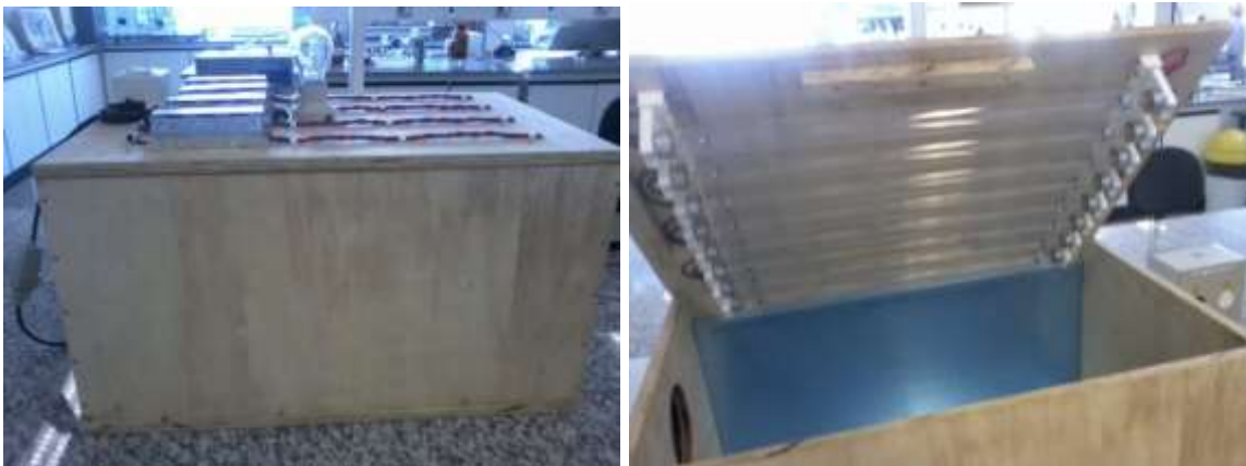
FIGURA 3.1 - Fotoreator utilizado nos experimentos de atividade fotocatalítica das amostras de nanopartículas de catalisadores, dopados ou não, em suspensão
