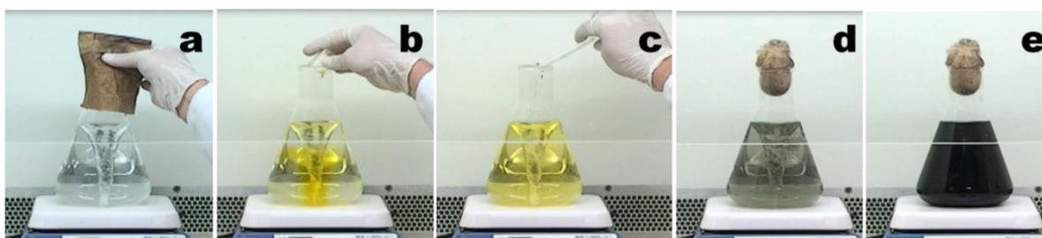
FIGURA 3.2 - Síntese de nanopartículas de ouro. **a)** Aquecimento 1000mL de água destilada à  $95^{\circ}\text{C}$ ; **b)** Adição de 20 mL de uma solução aquosa de  $\text{HAuCl}_4$  a  $5,0 \cdot 10^{-2} \text{ mol.L}^{-1}$ ; **c)** Adição de 10 mL de uma solução em citrato de sódio a  $3,0 \cdot 10^{-1} \text{ mol.L}^{-1}$ ; **d)** Nucleação das primeiras partículas de ouro; **e)** Depois de doze minutos de reação o coloide é resfriado à temperatura de  $23^{\circ}\text{C}$ .
