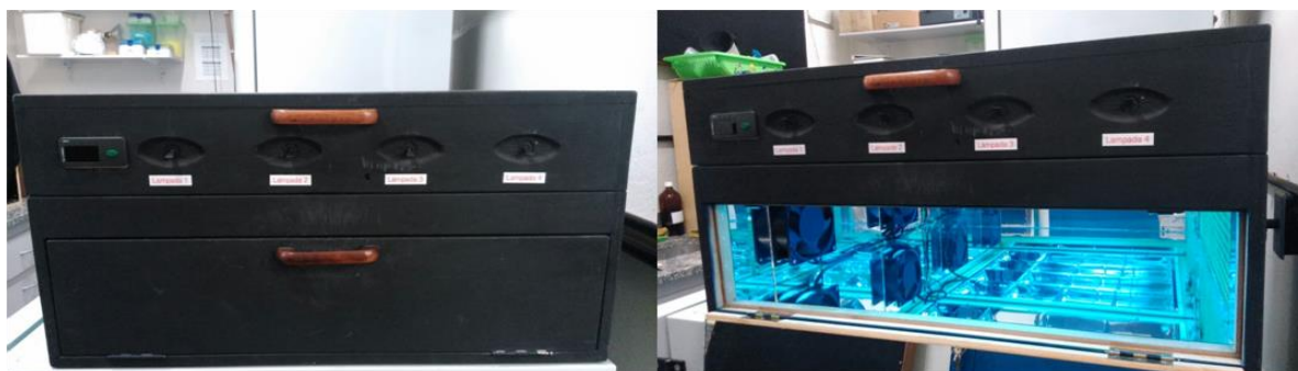
FIGURA 3.2 - Câmara de envelhecimento acelerado por luz ultravioleta.
