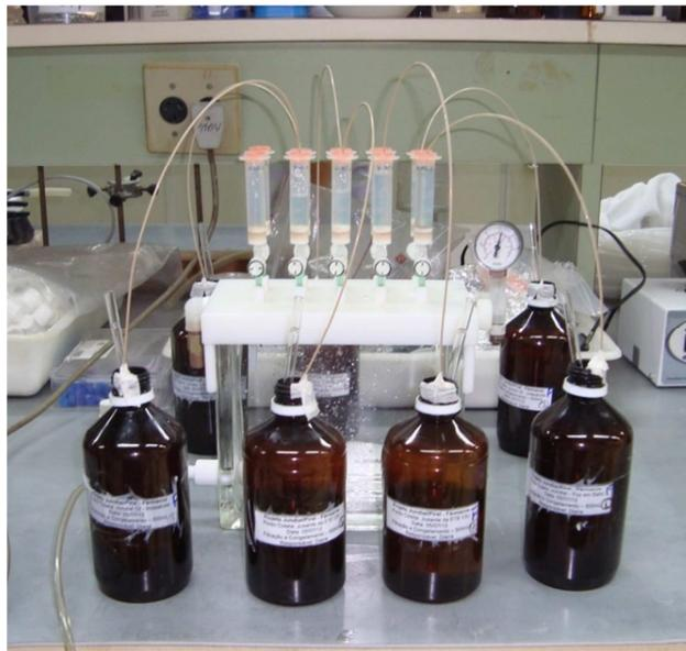
FIGURA 6.3 - Foto da configuração do sistema de extração a vácuo.
