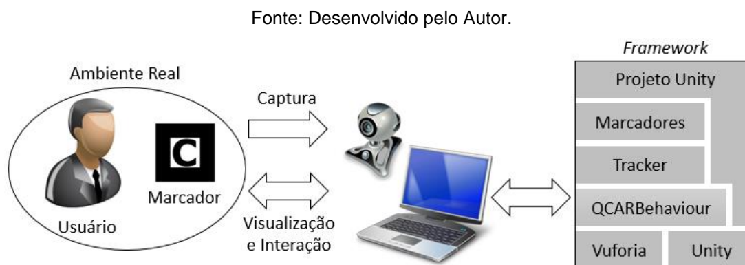
Figura 17 - Arquitetura geral do sistema.
