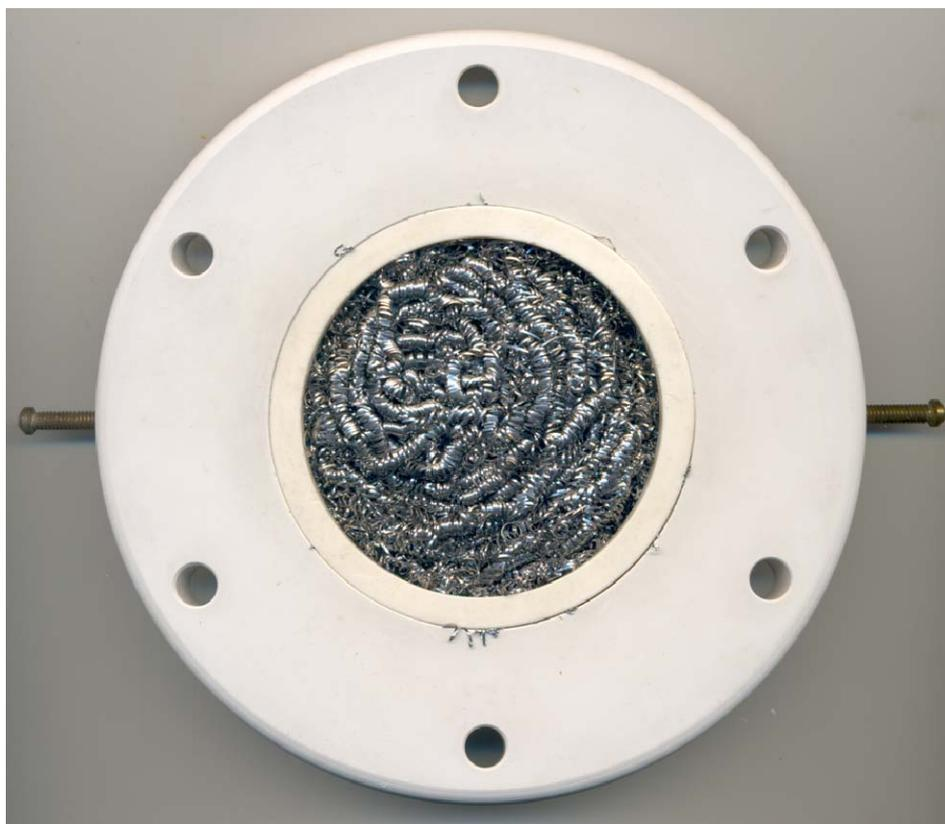
FIGURA 3.4 – Foto da esponja de aço inoxidável fixada no compartimento catódico do reator eletroquímico “flow-through”.
