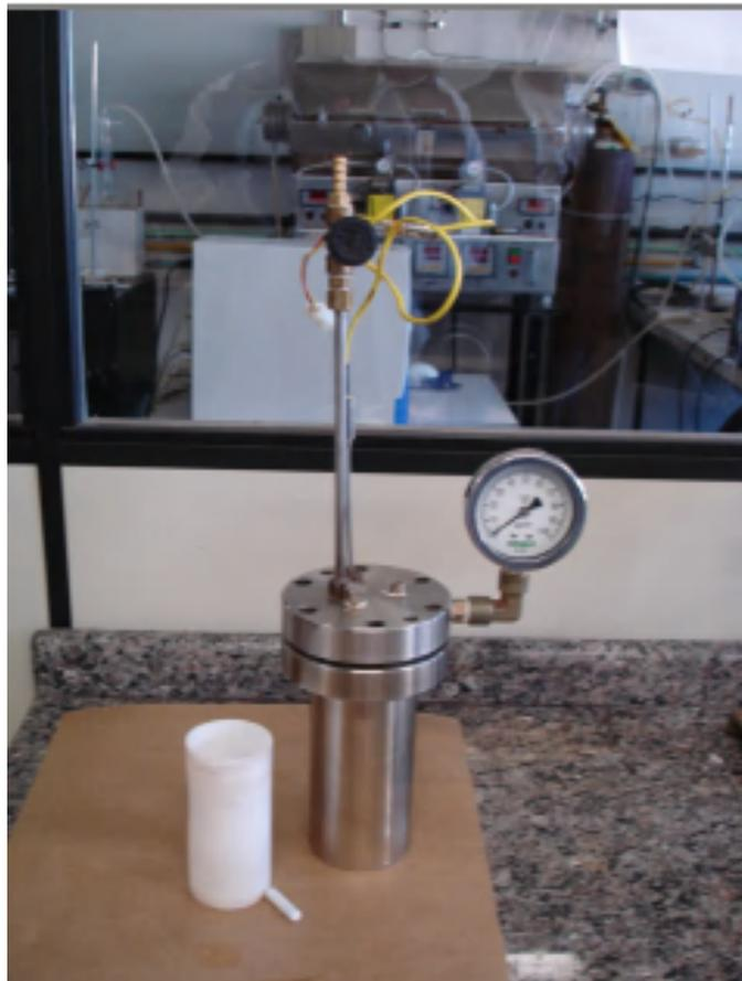
FIGURA 4.5 - Segundo protótipo construído. Abaixo, foto do equipamento com cápsula interna de teflon.
