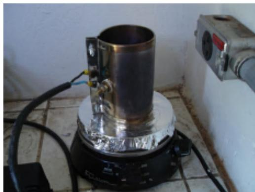
FIGURA 4.16 - Sistema de resistência coleira em aço inox montado sobre placa de agitação (disposição para uso com célula hidrotérmica).
