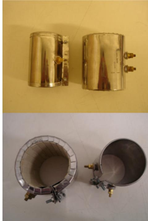
FIGURA 4.15 - Sistemas de resistência coleira com isolamento em cerâmica (temperaturas de até 750°C) e com isolamento mineral embutida em aço inox (temperaturas de até 350°C) em visão lateral e superior.
