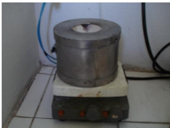
FIGURA 4.14 - Forno de aquecimento acoplado a sistema PID construído.
