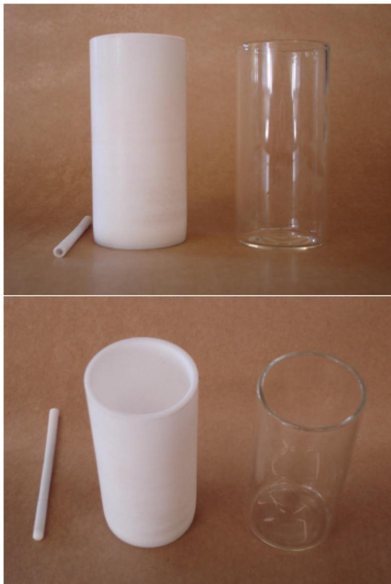
FIGURA 4.4 - Cápsulas de teflon e vidro borossilicato, em visão frontal e superior, utilizadas internamente à célula hidrotérmica para proteção das soluções de interesse. Lateralmente, bainha em teflon para termopar.
