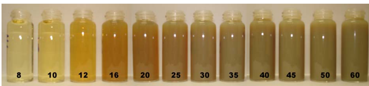
FIGURA 4. 24.: Imagens dispersões coloidais de prata nos tempos de aquecimento entre oito minutos a sessenta minutos da reação 90pH8. As amostras estão indicadas com um número que corresponde o tempo em minutos no qual esta alíquota foi retirada da reação sob aquecimento e resfriada a temperatura ambiente.
