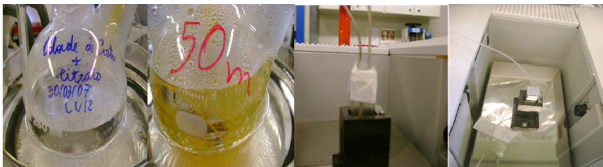
FIGURA 3. 2.: Imagem do balão antes e depois da reação e o arranjo das cubetas para análise on-line da reação de síntese de nanopartículas de prata
