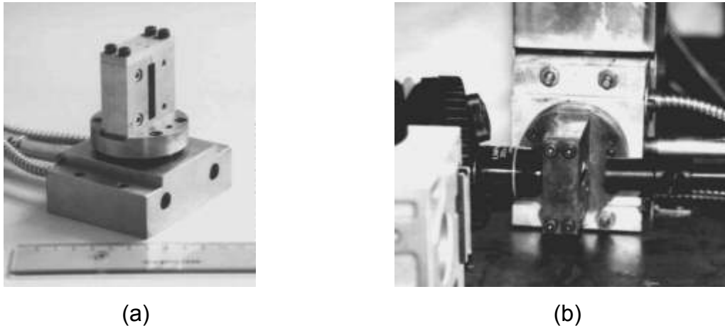
Figura 2.9. Aparato utilizado por Leukel et al. [56, 57]: (a) matriz; (b) conjunto composto pela matriz e microscópio acoplado na extrusora.
