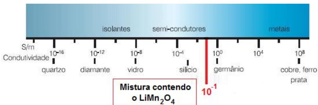
**FIGURA 4.21** – Representação esquemática de uma escala de condutividade elétrica, destacando a mistura  $\text{LiMn}_2\text{O}_4$  / negro de acetileno / PVDF.
