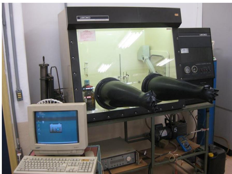
**FIGURA 3.6** – Câmara seca empregada nas medidas eletroquímicas usando lítio metálico.
