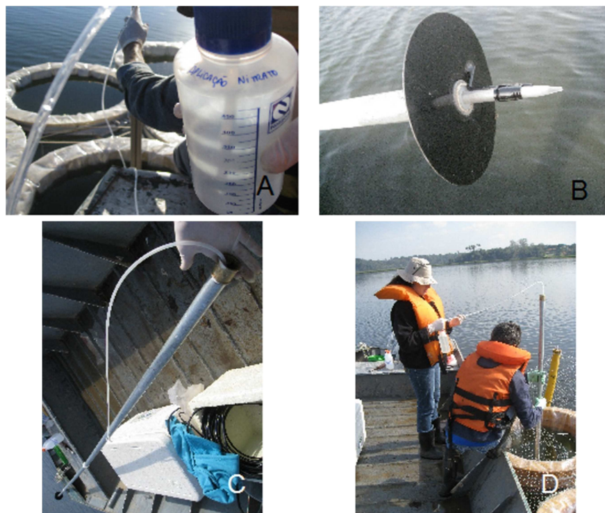
FIGURA 6.6- (A) Solução de nitrato de cálcio na pisseta, (B) ponteira de aplicação, (C) aparato de aplicação e (D) aplicação do nitrato de cálcio no sedimento.
