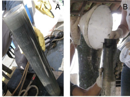
FIGURA 6.1- (A) Tubo coletor “K-B” com sedimento e (B) sedimento sendo fatiado em atmosfera de nitrogênio gasoso.
