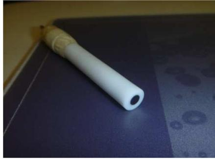
**Figura 3.1** Fotografia do eletrodo de carbono vítreo
