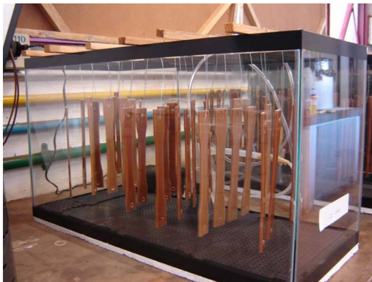
Figura 3.2 Corpos de prova que foram submetidos ao ensaio de biodegradação.
