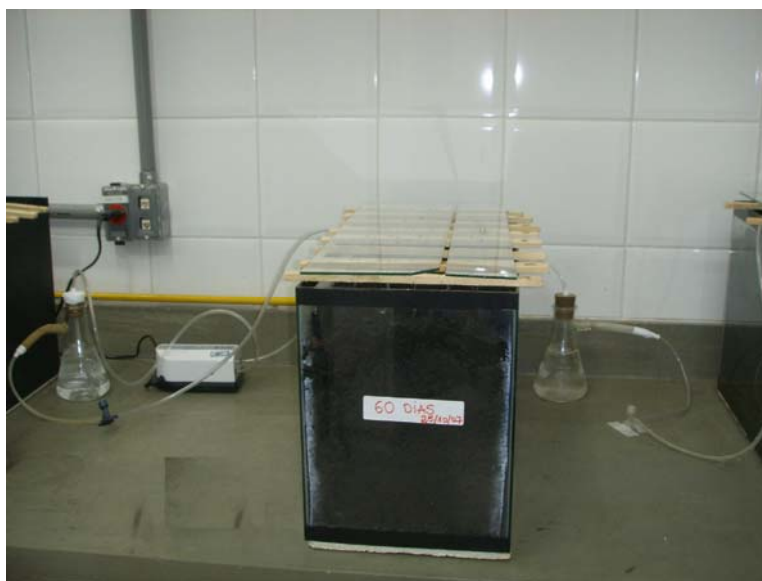
Figura 3.3 Esquema ilustrativo do ensaio de Biodegradação.
