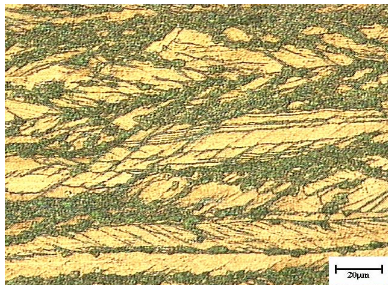
Figura 4.26 Microscopias óticas (500 x) de amostras tratadas por 20 minutos, na temperaturas de 700°C.
