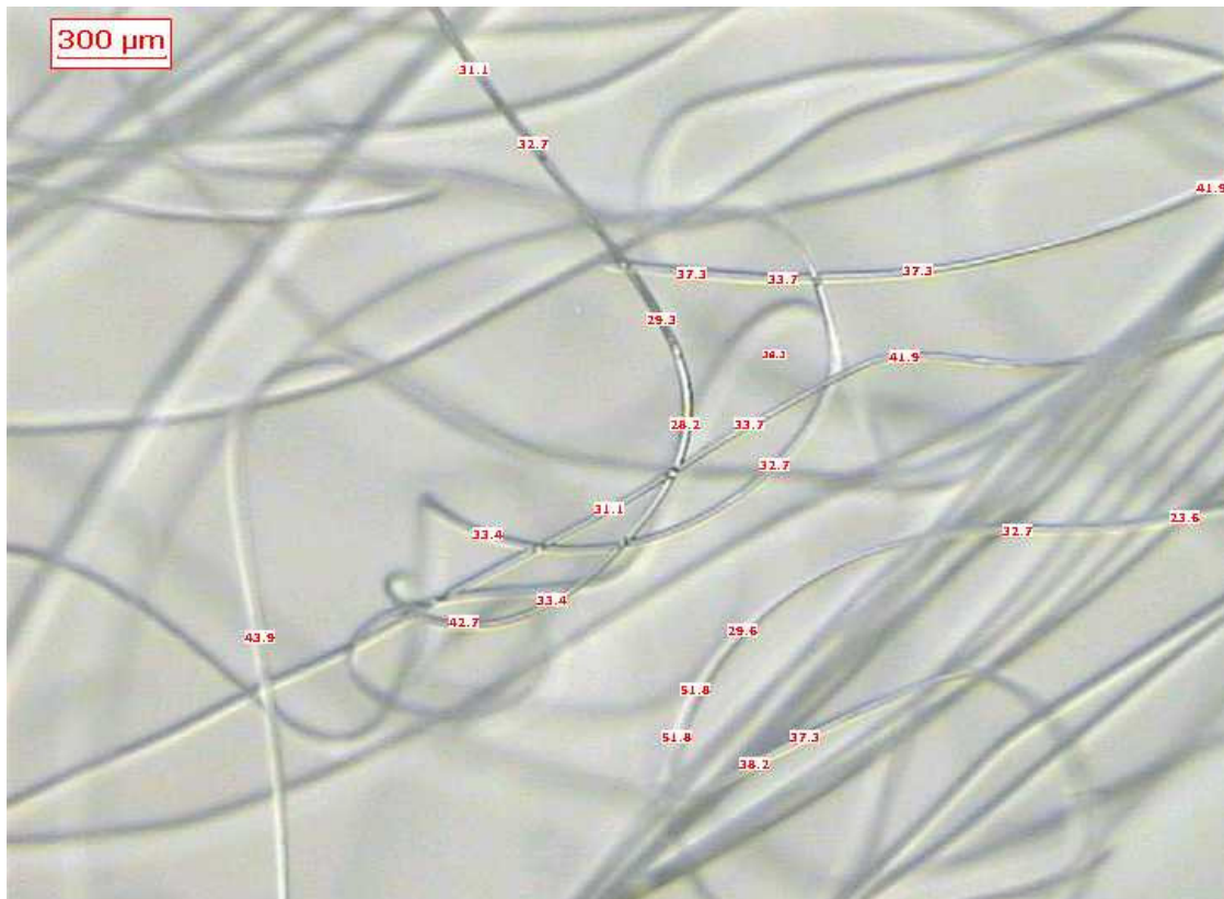
Figura 5.11- Micrografia ótica das fibras retiradas de uma manga filtrante nova.
