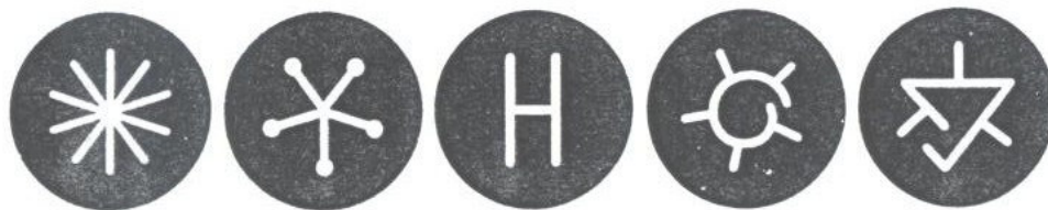
FIGURA 2.2- Algumas aberturas das feiras para a produção de fibras perfiladas (13).
