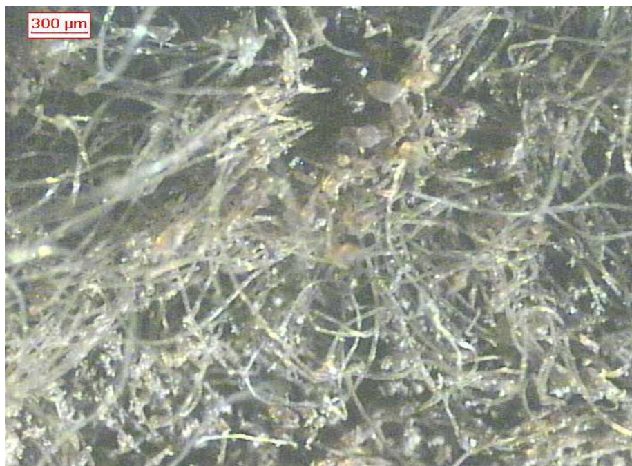
FIGURA 5.13- Micrografia ótica da face interna da manga filtrante usada, retirada do sistema de purificação de gases.
