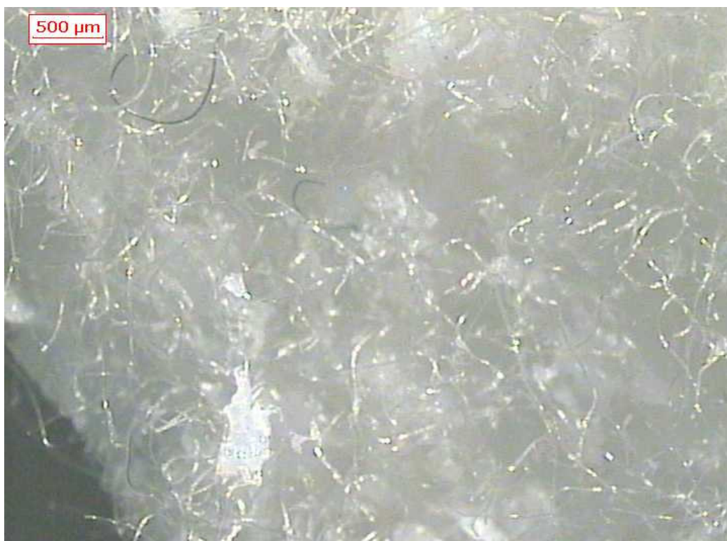
Figura 5.10- Face externa da manga filtrante onde se fez a operação de raspagem.
