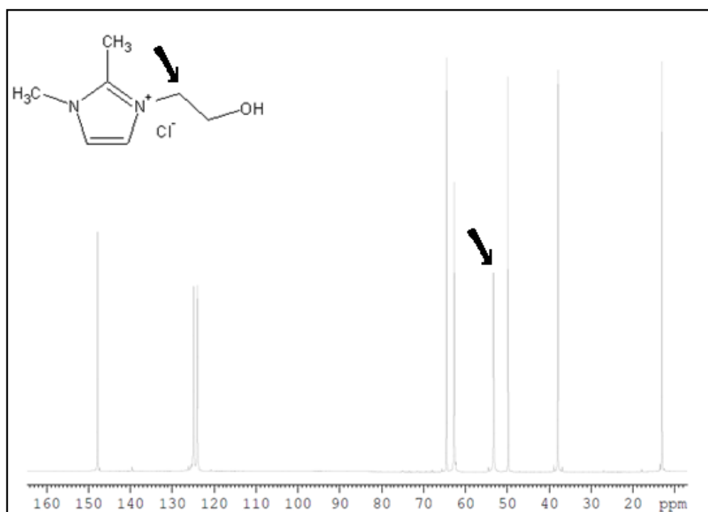
FIGURA 3.2- Espectro 13 C-RMN do cloreto de 1-(2-hidroxiethyl)-2,3-dimetilimidazolina.
