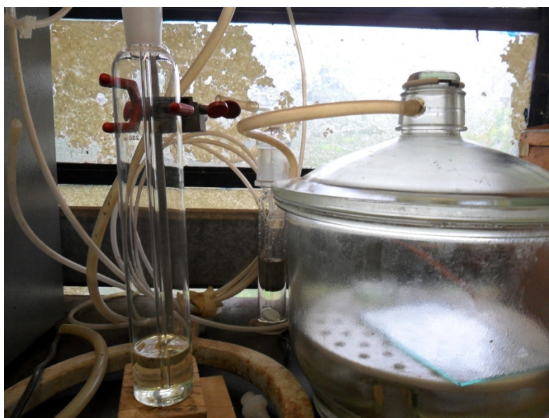
FIGURA 2.5- Preparo das membranas em atmosfera saturada de diclorometano.
