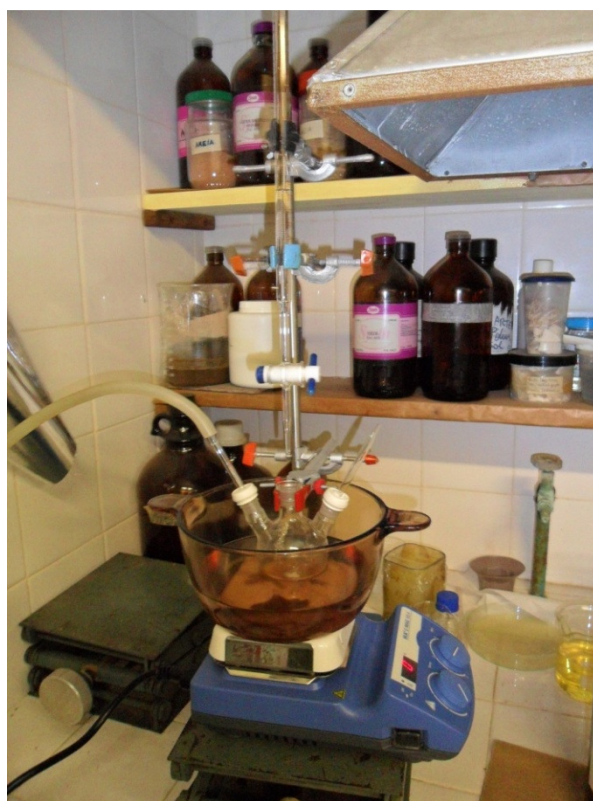
FIGURA 2.1- Síntese do Cloreto de 1-(2-hidroxietil)-2,3-dimetilimidazolina (LI 1).
