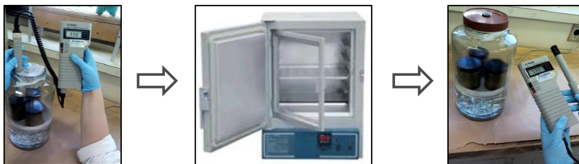
Figura 4.6.1-1 - Procedimento para realizar o estudo da estabilidade a curto prazo no material de solo candidato a MR.
