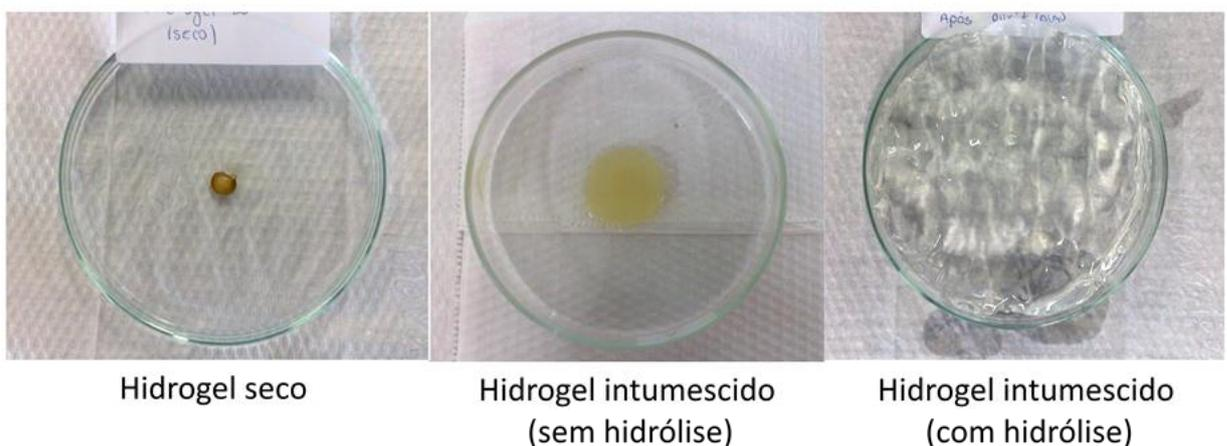
FIGURA 4.11 - Fotografia digital do hidrogel (1:1), seco, intumescido sem e com o tratamento de hidrólise.
