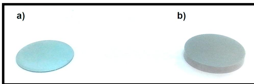
FIGURA 3.1 - Eletrodos de trabalho de Ti cp: a) discos construídos a partir da folha com espessura de 0,2 mm e b) discos de ~2 mm de espessura construídos a partir de uma barra cilíndrica.
