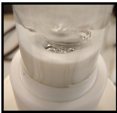
FIGURA 4.15 - Bolhas aderidas à superfície da amostra durante a realização das curvas cronopotenciométricas, utilizando o sistema com agitação mecânica.
