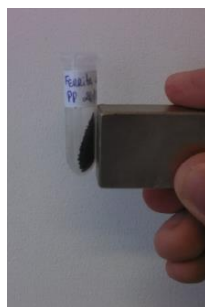
FIGURA 4.47 – Fotografia apresentando a propriedade magnética da amostra de \text{Nb}_2\text{O}_5 impregnada com \text{CoFe}_2\text{O}_4 .
