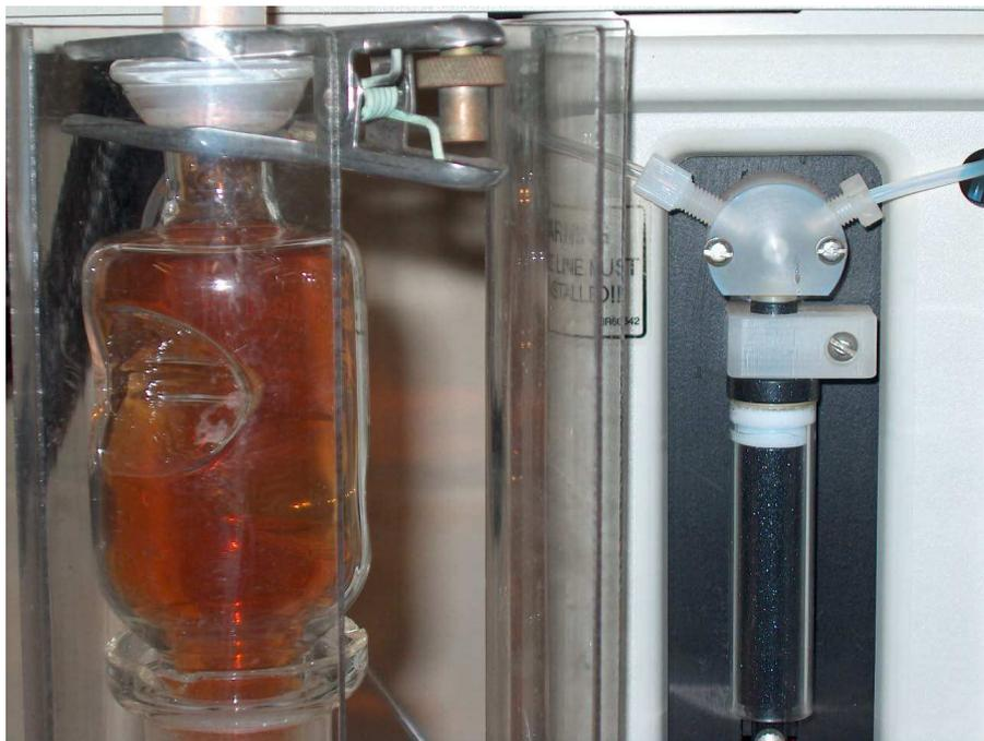
FIGURA 4.4. Seringa do forno de microondas com radiação focalizada responsável pela adição de reagentes e amostras ao longo de programas de aquecimento.
