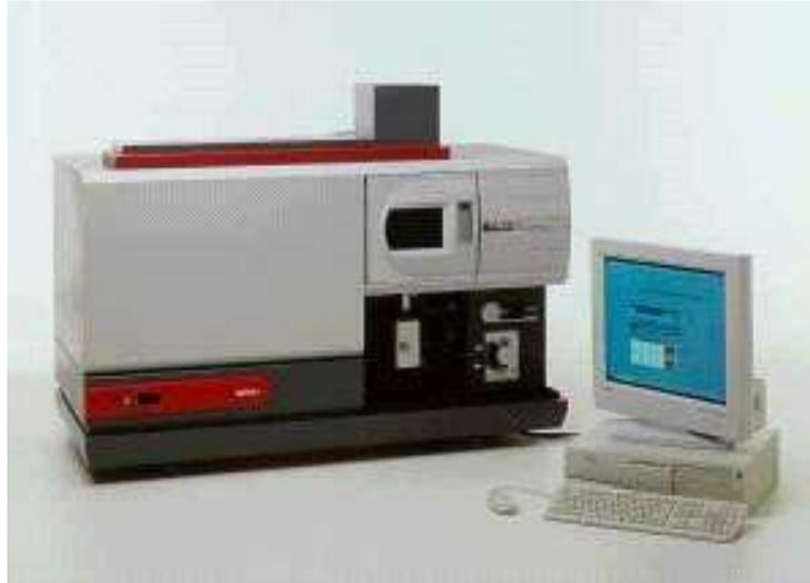
FIGURA 4.8. ICP-OES com configuração axial (Vista AX, Varian).
