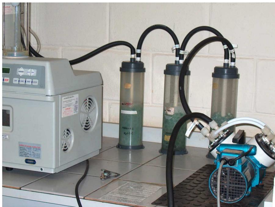
FIGURA 4.5. Frascos lavadores para coleta e neutralização dos vapores ácidos a partir de aspiração efetuada pela bomba de vácuo.
