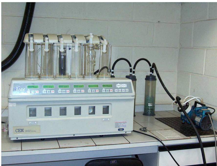
FIGURA 4.3. Forno de microondas com radiação focalizada.
