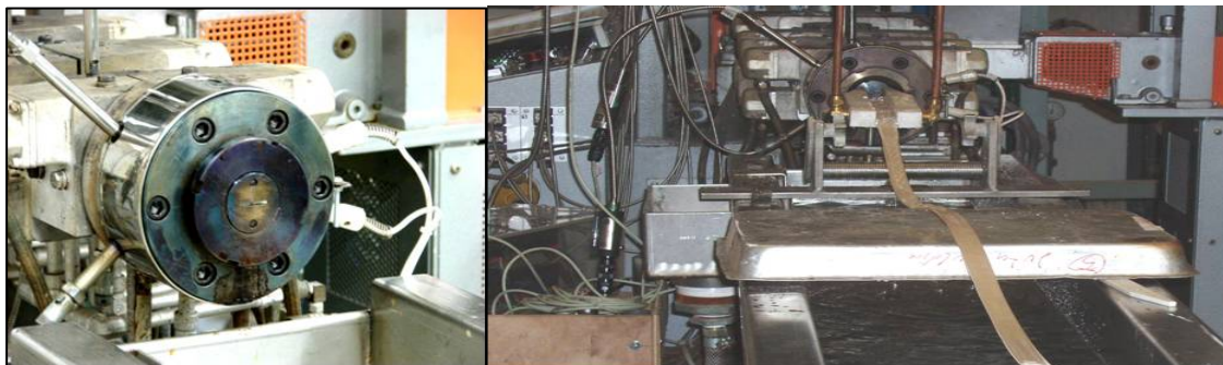
Figura 4.4 Cabeçote e Matriz para obtenção de placas 3 mm x 20mm para ensaios de EWF , desenvolvido por Ambrósio [73].
